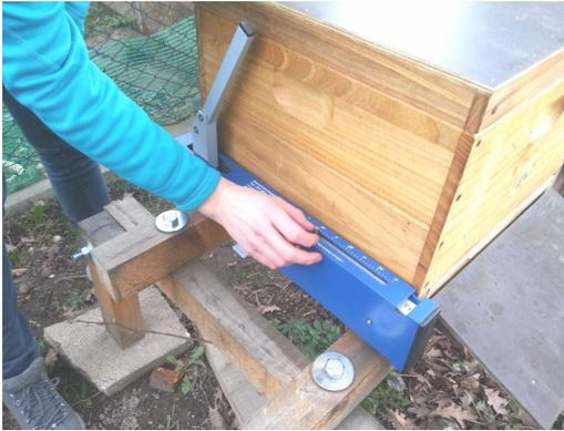
Nach dem Ausbalancieren, soll sich die Oberkante des Wiegebalkens mit der Ablesekante auf gleicher Höhe befinden und das Gehäuse nicht berühren.
