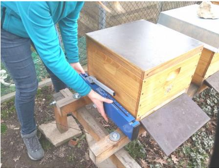
Der Haken der Bienenstockwaage muss dabei unter den Bienenstock einhaken.
