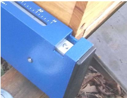
An der Skala der Bienenstockwaage kann nach dem Ausbalancieren das Gewicht der angehobenen Seite des Bienenstocks abgelesen werden.
