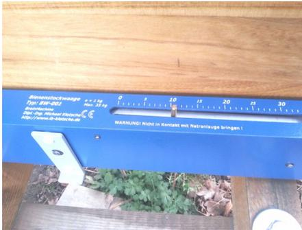
Um die Masse eines Bienenstocks zu bestimmen, wird der Bienenstock an zwei gegenüberliegenden Seiten gewogen. Die beiden gemessenen Werte werden dann addiert. Daraus ergibt sich die Gesamte Masse des Bienenstocks.
