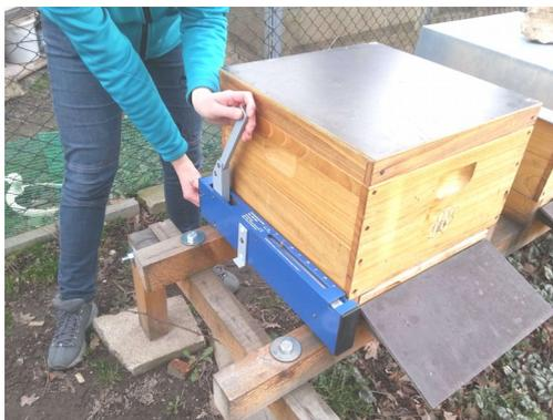
Wie in diesem Bild sollte der eingerastete Riegel aussehen.
