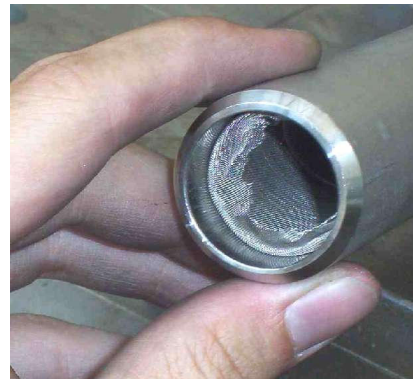
Heatpipe vor dem Anschweißen der Deckel Abb. 2.3 -17
