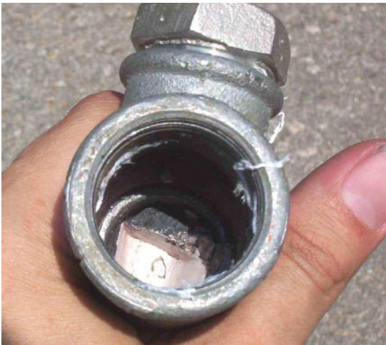
Natriumabscheider mit Teeren. Die Teerschicht wurde aufgekrazt Unter der Teerschicht glänzt das Natrium Abb. 4.3-1
