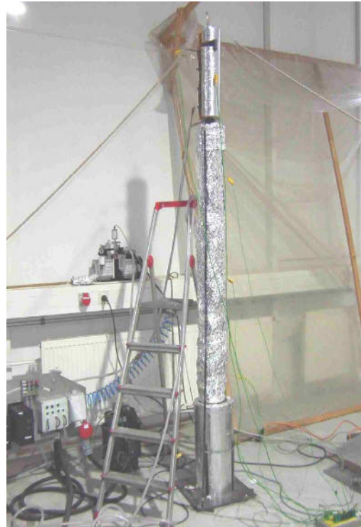
Untersuchung der Heatpipes von 2,5 m Länge. (1) Heizwendel, (2) Ofen, (3) Heatpipe, (4) Kühler, (5) Isolation. (6) Thermoelement, Abb. 2.4-5
