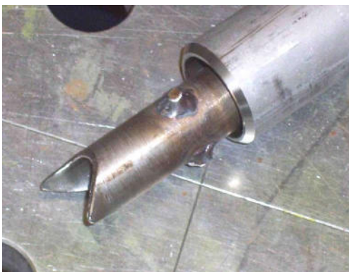
Thermosiphon mit Innenrohr vor dem Anschweißen der Deckel Abb 2.3-16
