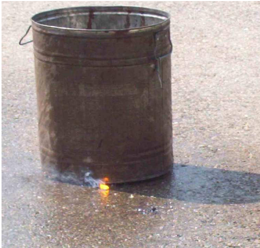
Im optimalen Fall verbrennt das Natrium ohne das der Wasserstoff explodiert. Natrium wird aus sicherer Entfernung mit Wasser besprüht Abb. 6.1-1
