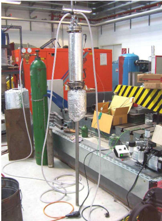
Befüllanlage mit angeschlossener Heatpipe. Abb. 2.3-4
