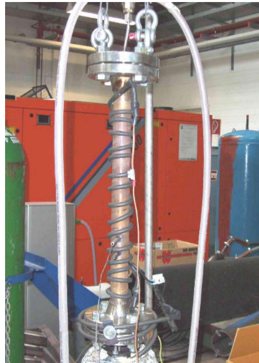
Befüllanlage ohne Isolation Abb. 2.3-5
